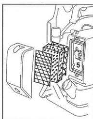
Les filtres à air sales réduisent la puissance du moteur, augmentent la consommation de carburant et rendent le démarrage plus difficile.
